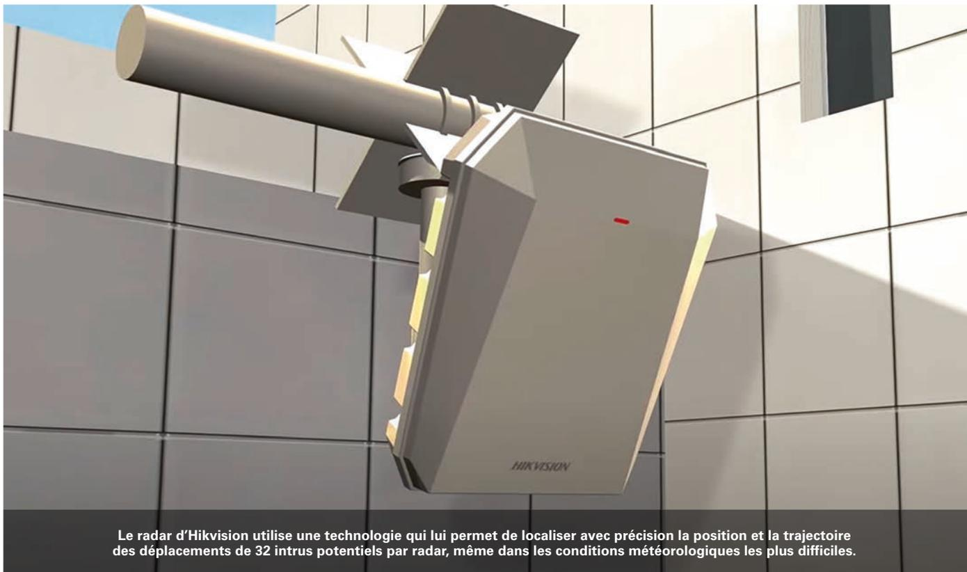
Le radar d'Hikvision utilise une technologie qui lui permet de localiser avec précision la position et la trajectoire des déplacements de 32 intrus potentiels par radar, même dans les conditions météorologiques les plus difficiles.
