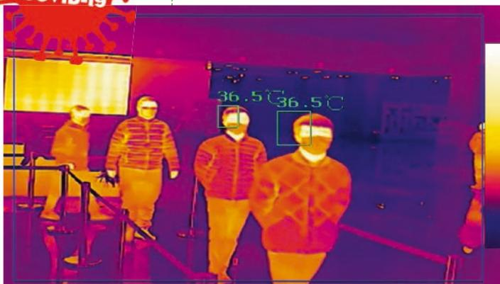
Avec des détecteurs et des algorithmes avancés, les caméras thermographiques de détection de température corporelle de Hikvision sont conçues pour détecter des températures élevées à la surface de la peau et peuvent ainsi être utilisées pour le dépistage rapide et préliminaire de la fièvre dans les immeubles de bureaux, usines, gares, aéroports et autres lieux publics, avec une précision allant jusqu'à  $\pm 0,3^\circ\text{C}$ .
